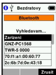
5. Použijte šipky a vyberte zařízení, ke kterému se chcete připojit a stiskněte **OK**. Status připojení se změní na **Zkouším se připojit...**
