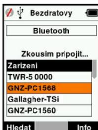
**Poznámka:** Čtečka HR4 může být nastavena na posílání a/nebo příjem dat z jiných zařízení přes Bluetooth.
