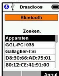
5. Gebruik de pijltoetsen om een apparaat te selecteren om verbinding mee te krijgen en druk op de knop OK. De verbindingstatus verandert in **Koppelen...**
